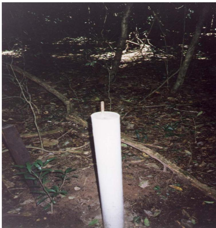
Figura 2.2.1. Marcos de concreto revestidos por um tubo de PVC branco.
