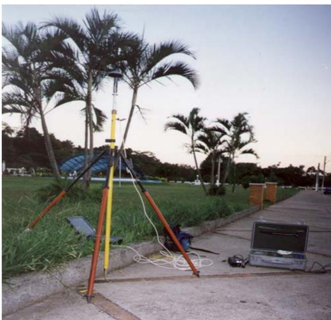
Figura 2.3.1. Receptor Trimble modelo Pro XR
